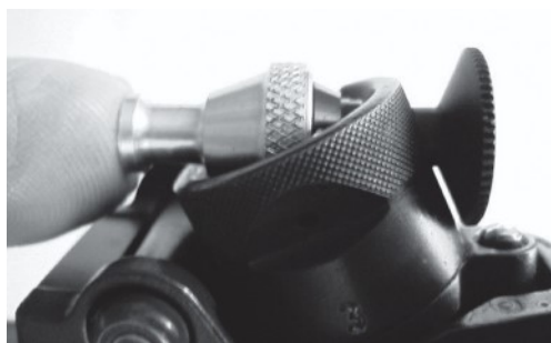
Figura 8: sistema di filtri colorati Wyss innestabile
