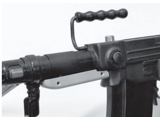
Figure 32: Garde-main pour F ass 57
