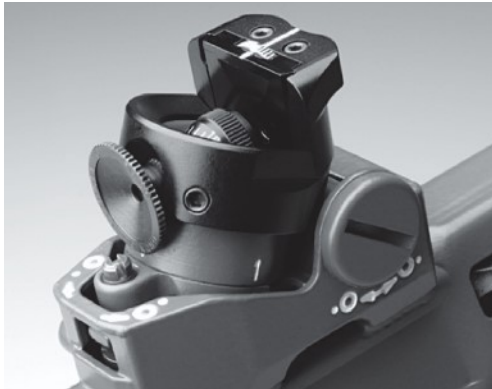
Bild 7: Excenter-Farbenfilter mit Schiebekassette zu Stgw 90, Modell Grünig & Elmiger; Modell Wyss ähnlich
