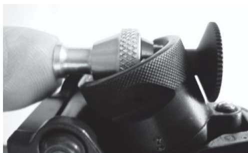
Figure 8: Système de filtres colorés Wyss emboîté
