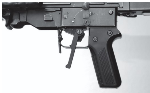
Figura 33: grilletto ausiliario d'inverno per F ass 57
