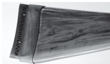
Figure 38: Sabot de crosse 50 mm pour mousqueton 31
