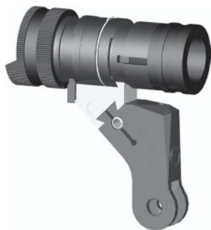
Bild 24: Universalkornträger zu Stgw 57 (Normalmontage), diverse Fabrikate
