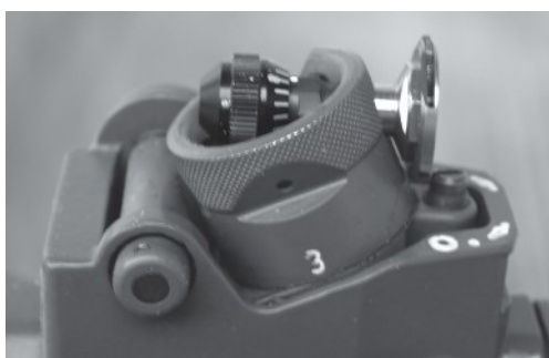
Figura 6: diaframma ad iride per F ass 90 (con o senza filtri), diversi modelli
