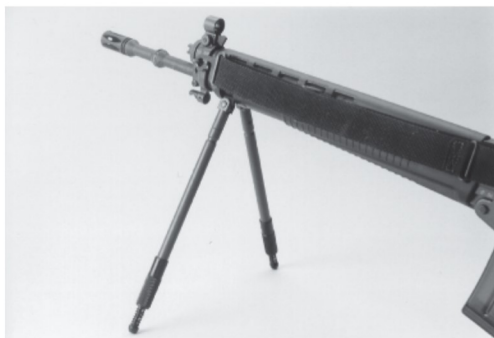
Bild 2: Verstellbare Zweibeinstütze zu Stgw 90, diverse Fabrikate
